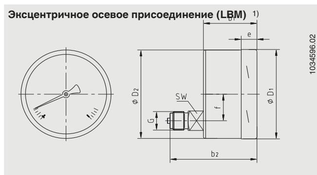
1) Расположение присоединения сзади только для манометров NS 63 и 100 без гидрозаполнения
